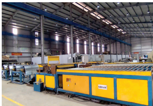
Dây chuyền sản xuất ống gió với máy Auto-line VI Krrass Duct production line with Autoline VI Krrass machine
